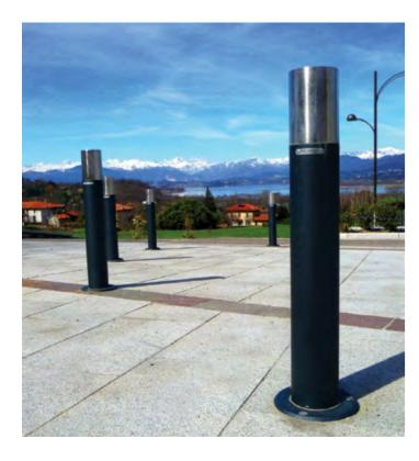
Balizador metálico em formato cilíndrico composto por dois elementos: o corpo em aço galvanizado e pintado e a parte superior em aço inox. Pré-disposto a fixação ao pavimento por parafusos ou diretamente concretado. Disponível em três tamanhos.
